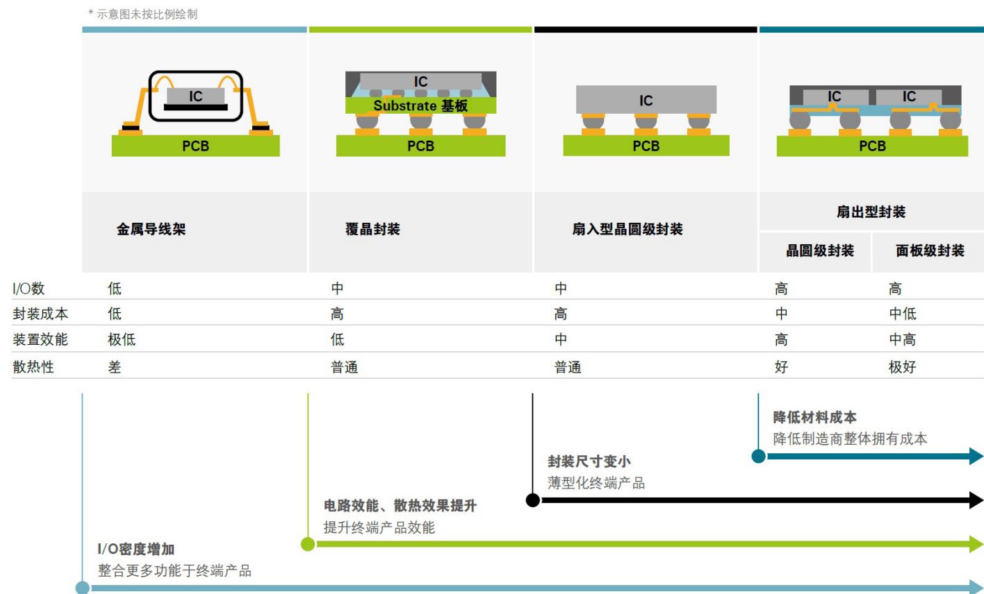
图3 封装技术的推进,有效降低封装厚度、大幅提升电子产品效能,降低材料成本 (来源:MANZ)
