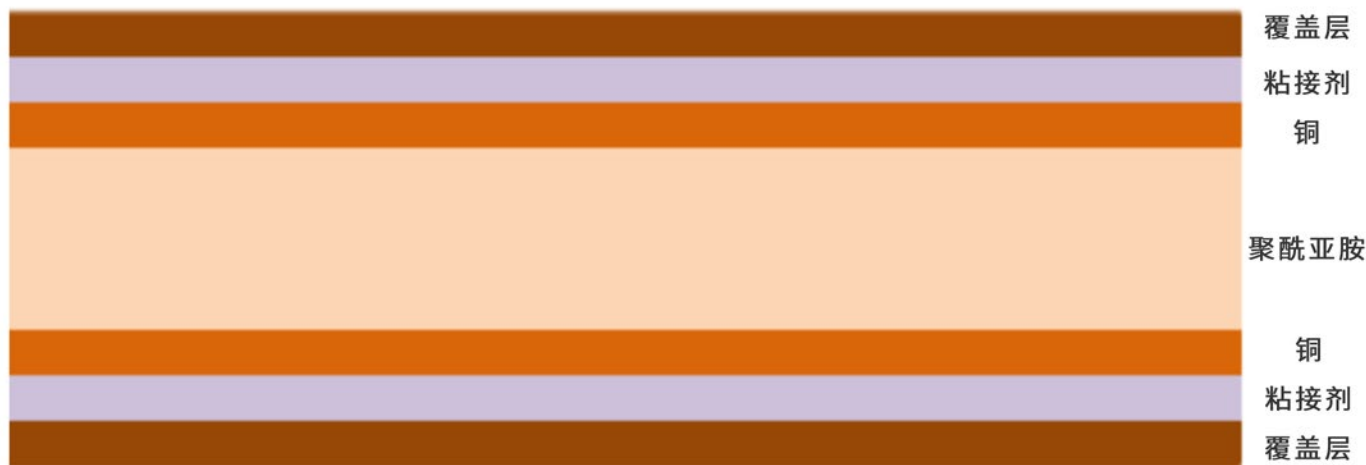
图6:对阻抗要求较高的双层结构图,受控阻抗部分的厚度增加,所以挠性降低
