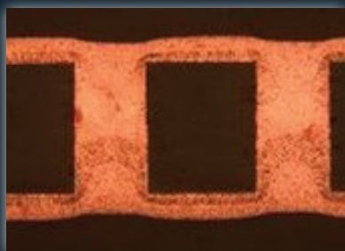
两步骤填通孔工艺
