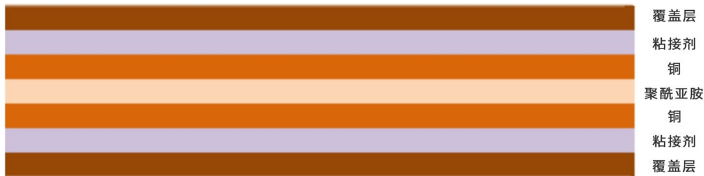
图5:标准双层电路结构图
